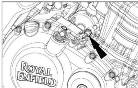
5. Ajuste la posición de la tuerca de ajuste interna para proporcionar un juego libre de 9 - 11 mm en el extremo de la bola de la palanca del embrague (desde su posición más alejada) antes del acoplamiento del motor.
