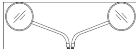
Este tipo de espejo está diseñado para proporcionar una vista mucho más amplia de la parte trasera que un espejo plano normal. Sin embargo, los vehículos y otros objetos vistos en este tipo de espejo se verán más pequeños y más lejanos que cuando se ven en un espejo plano.
