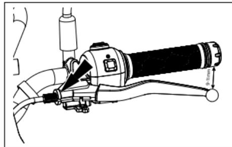
6. Tire de la palanca 3 veces y verifique la distancia de nuevo, ajuste de acuerdo con el procedimiento del punto anterior si es necesario.
