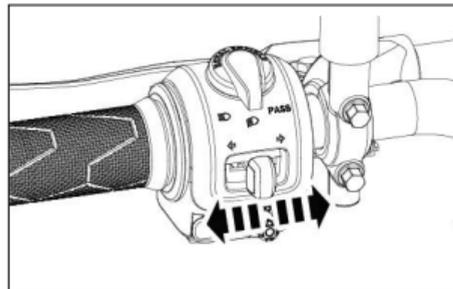
Presione el botón de posición APAGUE hacia la izquierda o hacia la derecha antes de girar para el lado correspondiente. Para cancelar las luces direccionales, presione el interruptor hacia adentro después de que haya regresado a la posición central.
